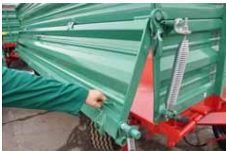
Verschiedene Möglichkeiten der abklappbaren Pendelbordwände mit Bordwandhebefedern:
