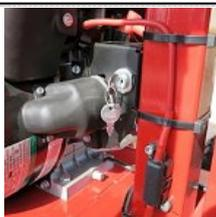
L'avvio manuale viene mantenuto (il motore può essere avviato, ad esempio, con una batteria scarica).
