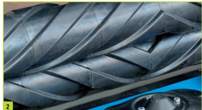
Le conditionnement avec les rouleaux s'effectue par écrasement et fragmentation de la tige afin de réduire la pellicule cireuse et de permettre son séchage en même temps que celui de la feuille.
