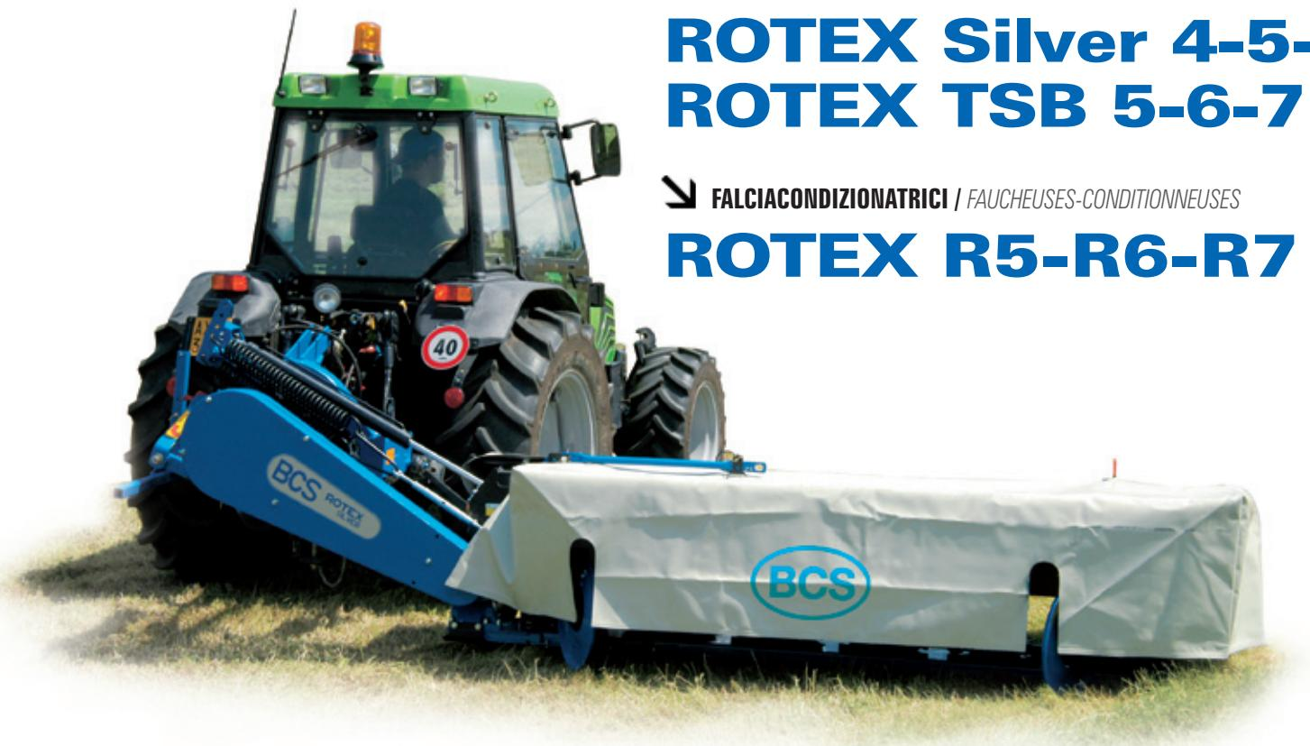
Le falciatrici a dischi portate posteriori sono alla base del progetto **ROTEX**. Disponibili nelle versioni **Silver 4**, **Silver 5**, **Silver 6** e **TSB 5**, **TSB 6** e **TSB 7** si differenziano tra di loro per le caratteristiche della struttura portante e del telaio che nella Silver è fisso, mentre nelle TSB è registrabile in larghezza per un migliore adattamento alle trattori di alta potenza.
