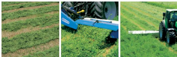
Les faucheuses arrière à disques portées sont à la base du projet **ROTEX**. Disponibles en versions: **Silver 4, Silver 5, Silver 6 et TSB 5, TSB 6 et TSB 7**, elles se différencient par les caractéristiques de la structure massive et du châssis qui est fixe pour la série **Silver** tandis que pour la série **TSB** il est réglable en largeur pour faciliter le montage sur tracteurs de grande puissance.
